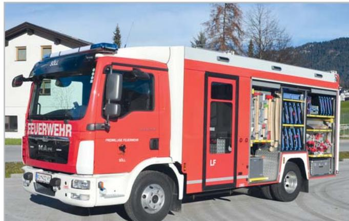
Ein Fahrgestell der Firma MAN bietet das Grundgerüst des neuen Löschfahrzeuges (LF), welches von der Zillertaler Firma Empl aufgebaut wurde. Mit 250 PS und einem 12-Gang automatisierten Schaltgetriebe sorgt es dafür, dass die freiwilligen Helfer rechtzeitig und sicher zur Einsatzstelle kommen. Neun Feuerwehrkameraden finden im Fahrzeug Platz. Voll automatisierte Großraumrollos er-
